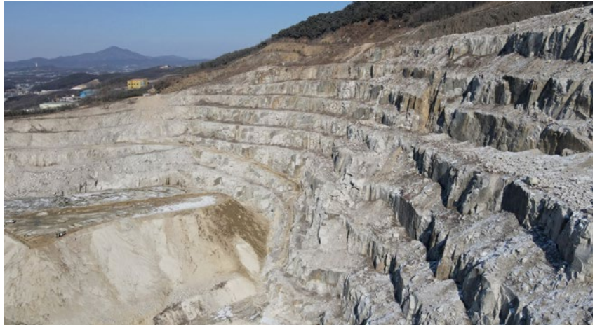
채석장 계단식 굴착 전경. 골재를 더는 채취할 수 있는 곳이 없을 정도로 슬러지 하부에서 무리하게 굴착 작업을 강행했다
