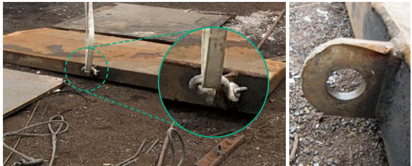
재해자가 줄걸이를 할 때 방열판 러그에 샤클을 사용하지 않고 섬유벨트를 묶어서 연결했다
