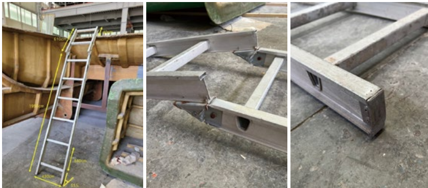
사업장에서 임의로 개조한 A형 사다리. 한쪽 면이 절단되었으며 하부에는 미끄럼 방지 장치가 전무하다
