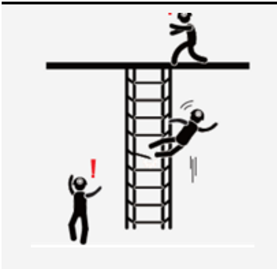
수직사다리를 오르던 중 발판이 파손되어 추락할 뻔한 사고
