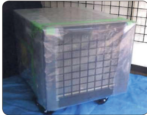
[그림 4-8] 이동 및 보관시 음압기 밀봉 예
