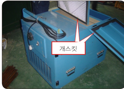
[그림 4-3] 공기누설 방지를 위한 개스킷 설치 예
