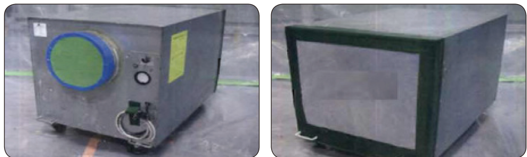
[그림 4-7] 음압기의 배기구(좌) 및 흡입구(우)의 밀봉 예
