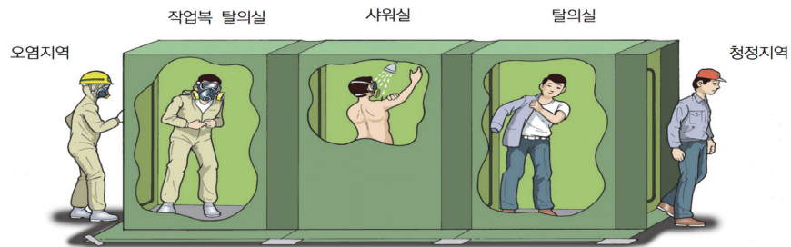
[그림 5-4] 위생설비 설치 및 사용
