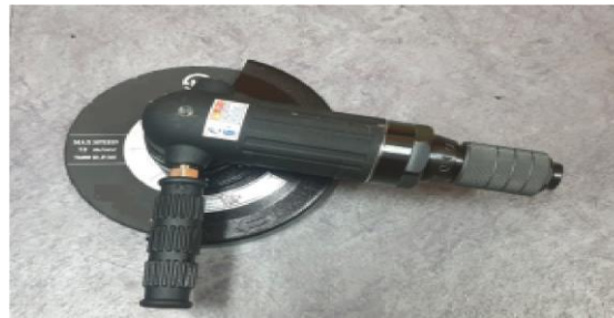
방호덮개 설치(공압식 예시)
