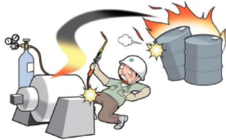
용접 불티가 유류에 튀어 화재·폭발
